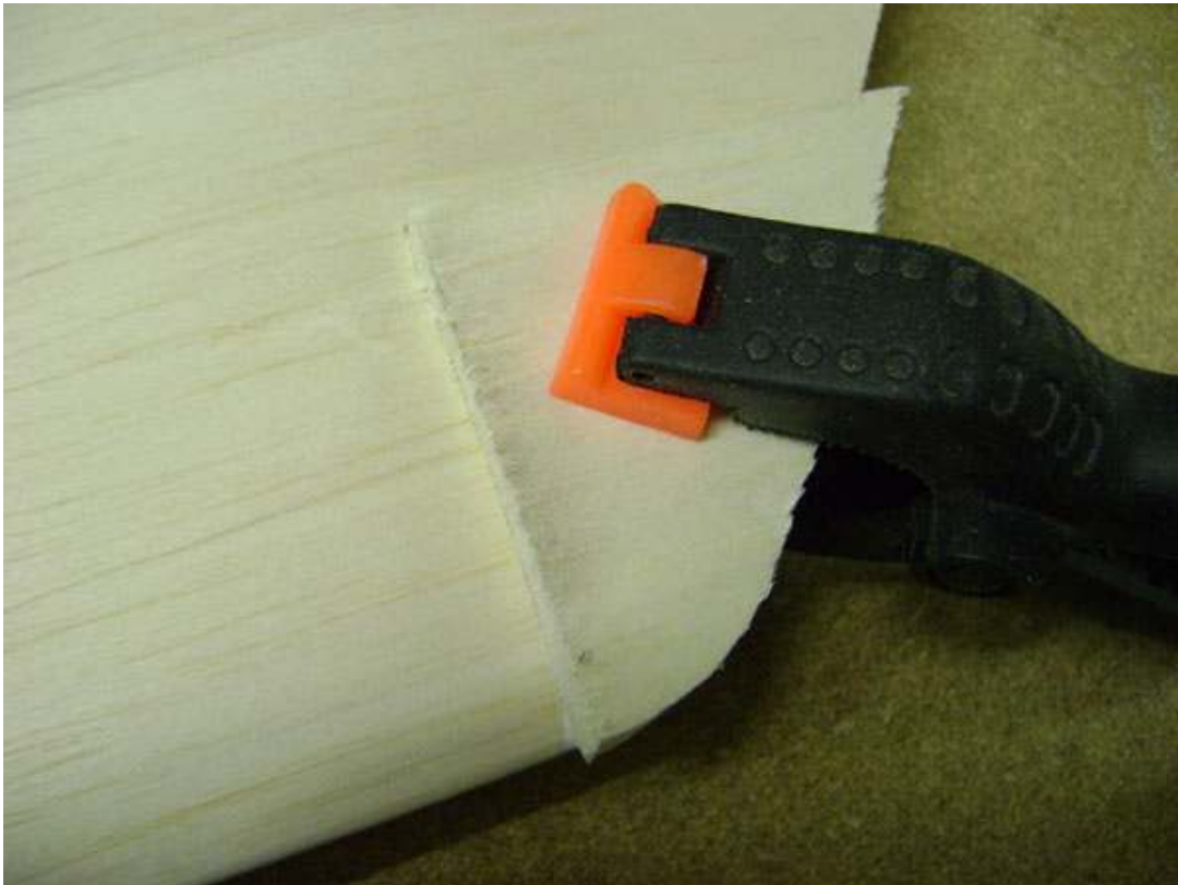
An den Randbogen wird die Beplankung abgeschnitten. Die Ecken werden mit Vollbalsa aufgefüllt und verschliffen.
