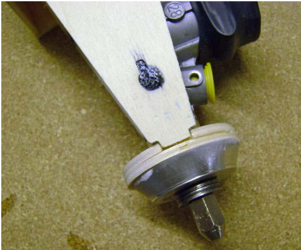
Die Ringe mit Maserung 90° zueinander verleimen
