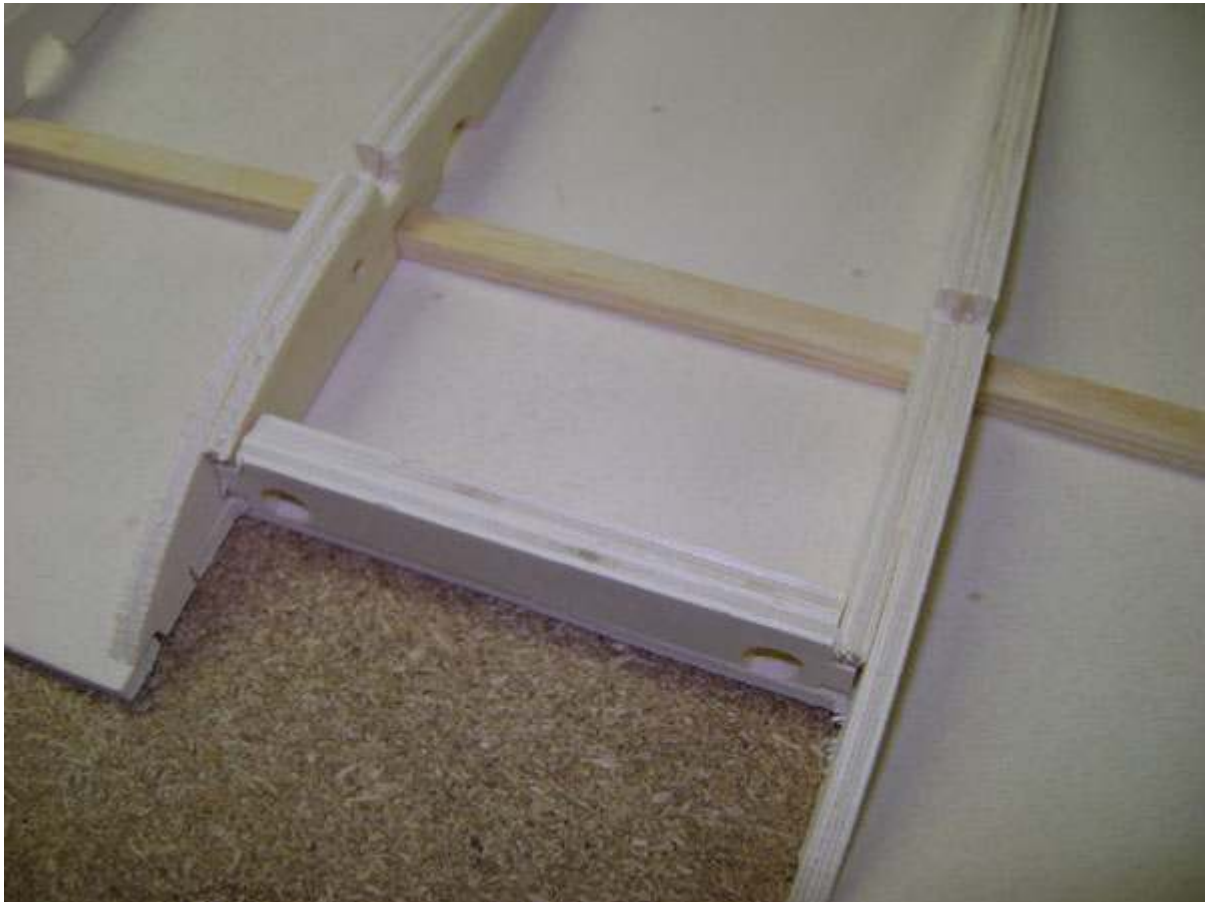
Dübelhalter und Doppelrippen werden im Bereich der Rumpfauflage eingeleimt.
