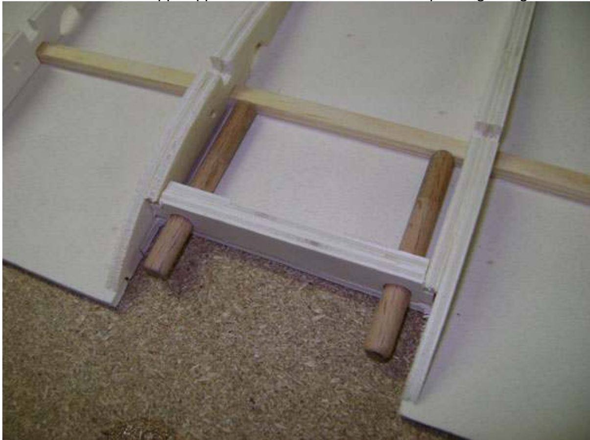
Dübel aus Buche 5mm zuschneiden. Diese können jetzt eingeharzt werden.
