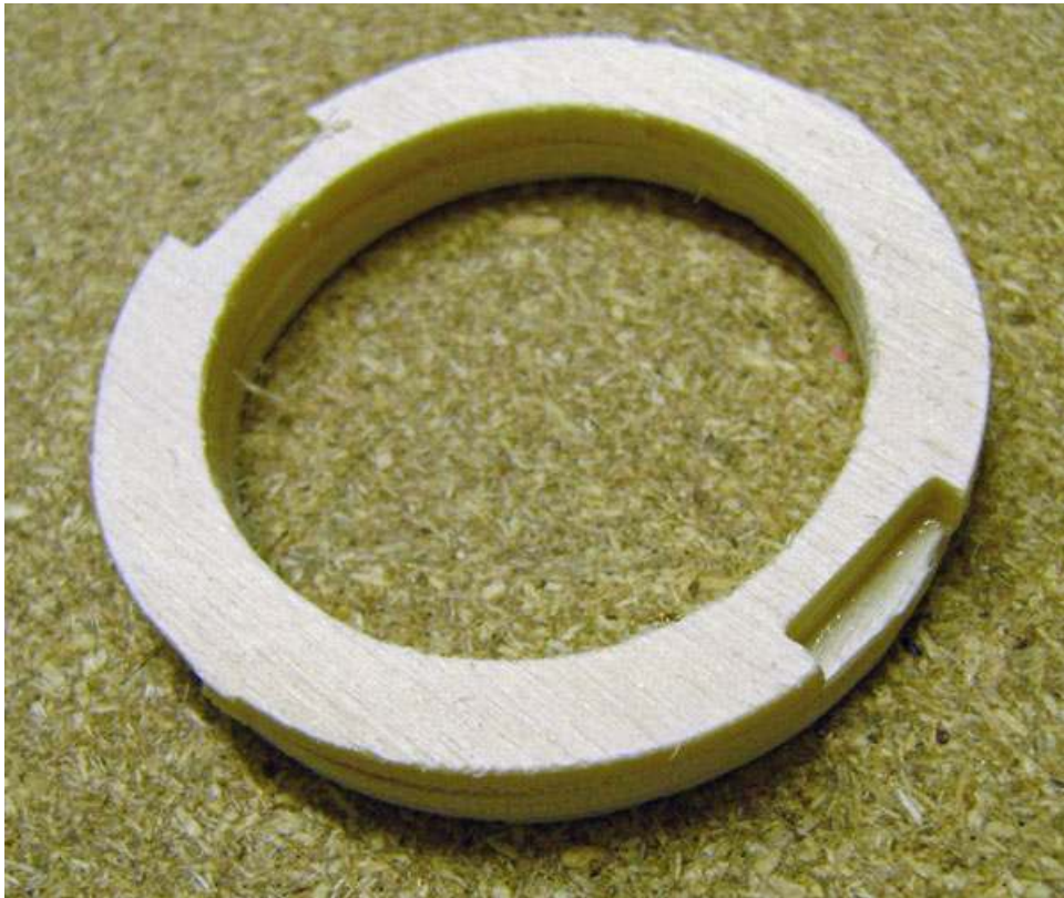
Die Ringe mit Maserung 90° zueinander verleimen
