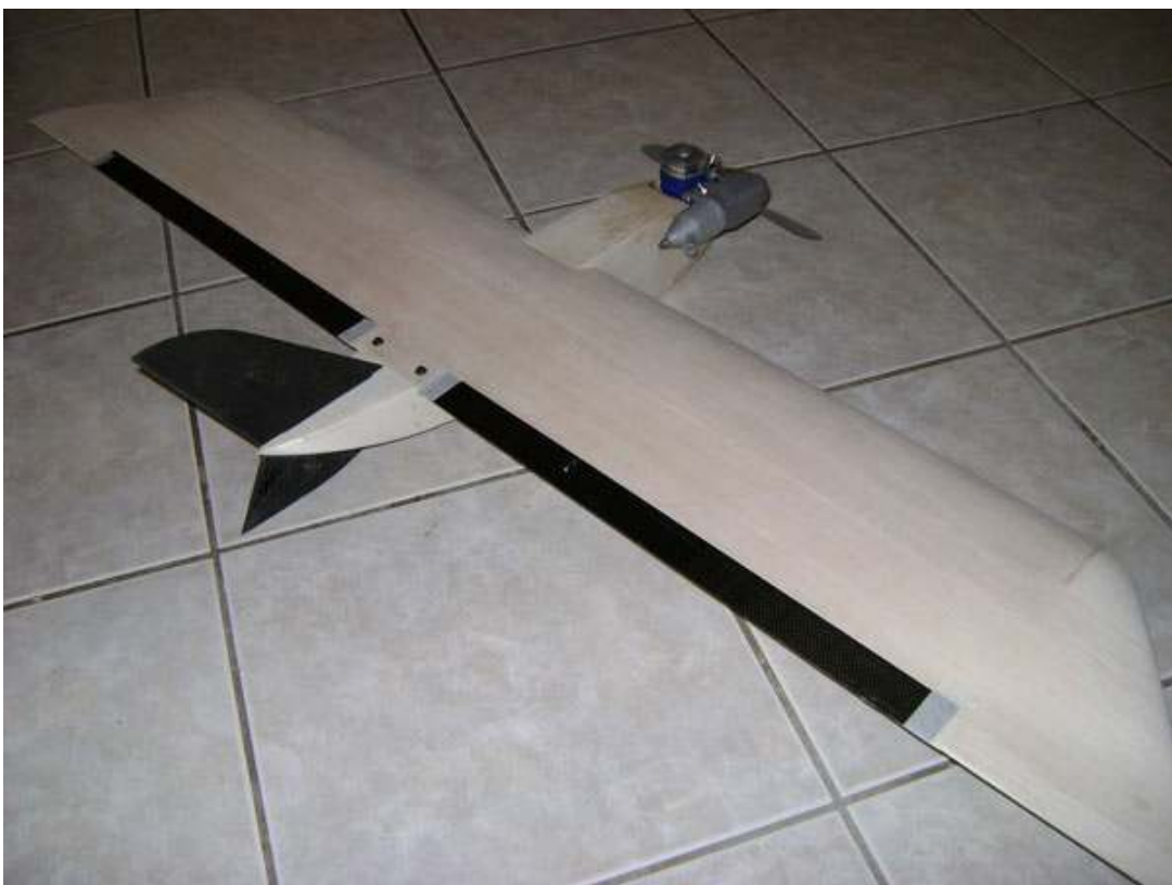
Die Ruderklappen aus Balsa anfertigen oder aus CFK herstellen. Dann alles sauber einpassen und verschleifen.
