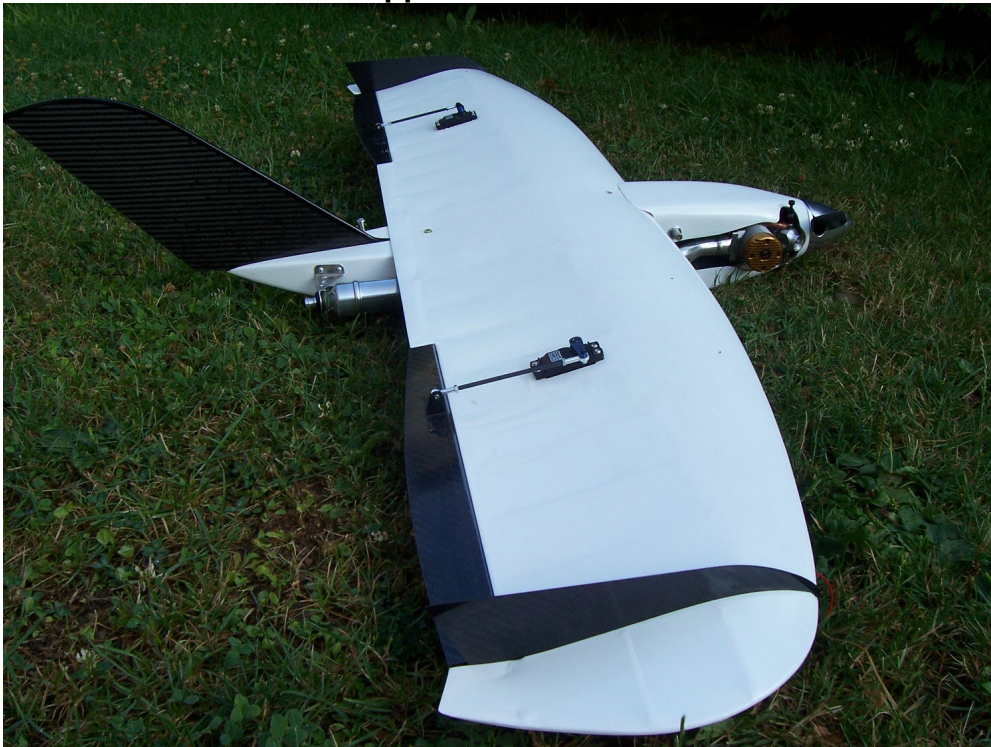
Auch hinten abgerundete Klappen sind möglich. Seitenflosse ist auch in 0,5er CFK mit Sperrholzgerippe erstellt. Nasenleiste der Flosse ist hier in Sperrholz mit Schwarzer Folie überzogen.
